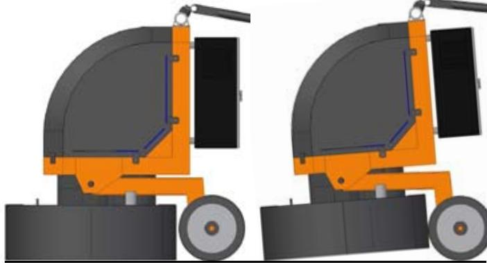
Controllo elettrico per l'inclinazione del planetario
